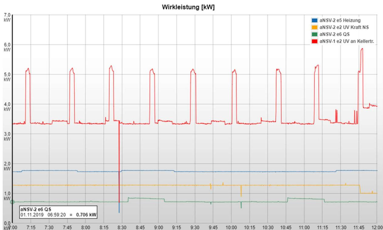
Abbildung 29: Darstellung der größten Verbraucher der Unterverteilung "alte NSV". Es wird der selbe Zeitraum am selben Tag wie in Abbildung 28 betrachtet. [10, 53]
